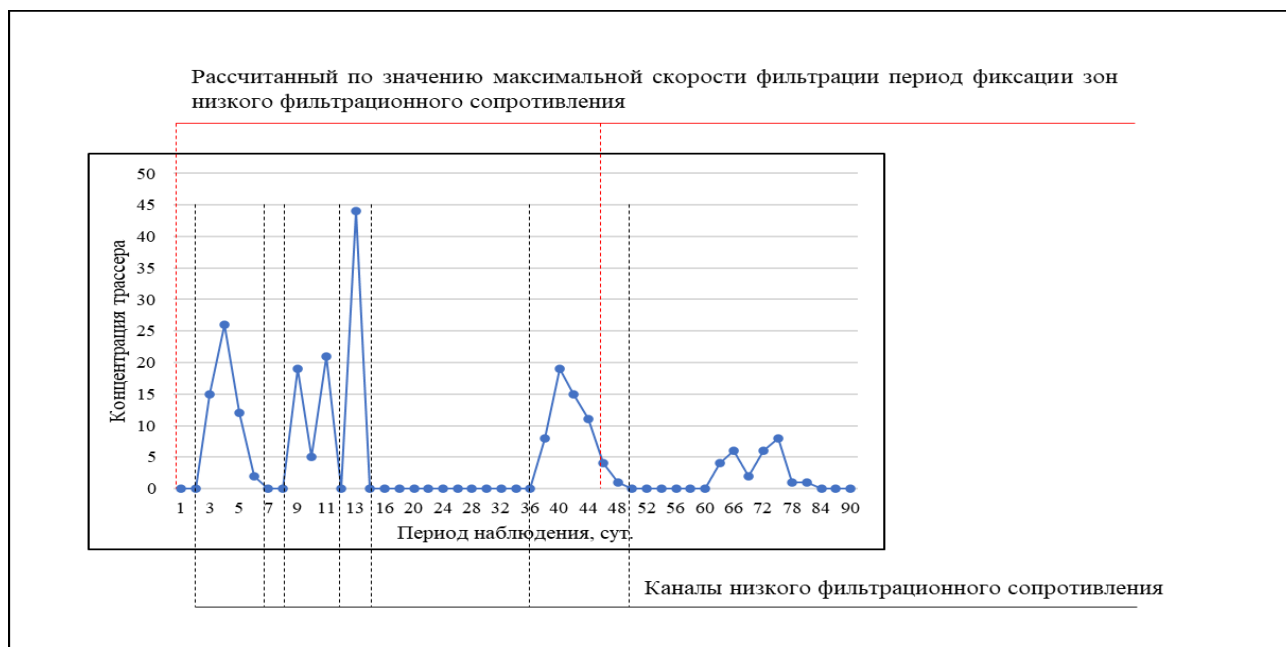
Рисунок 17 - Принципиальная схема обозначения наличия и активности зон низкого фильтрационного сопротивления по времени и динамике выхода трассера
