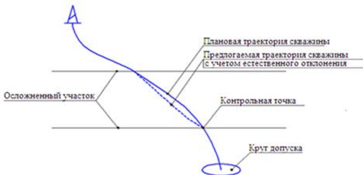
Рисунок 4 – Плановая и предлагаемая траектории ствола скважины
