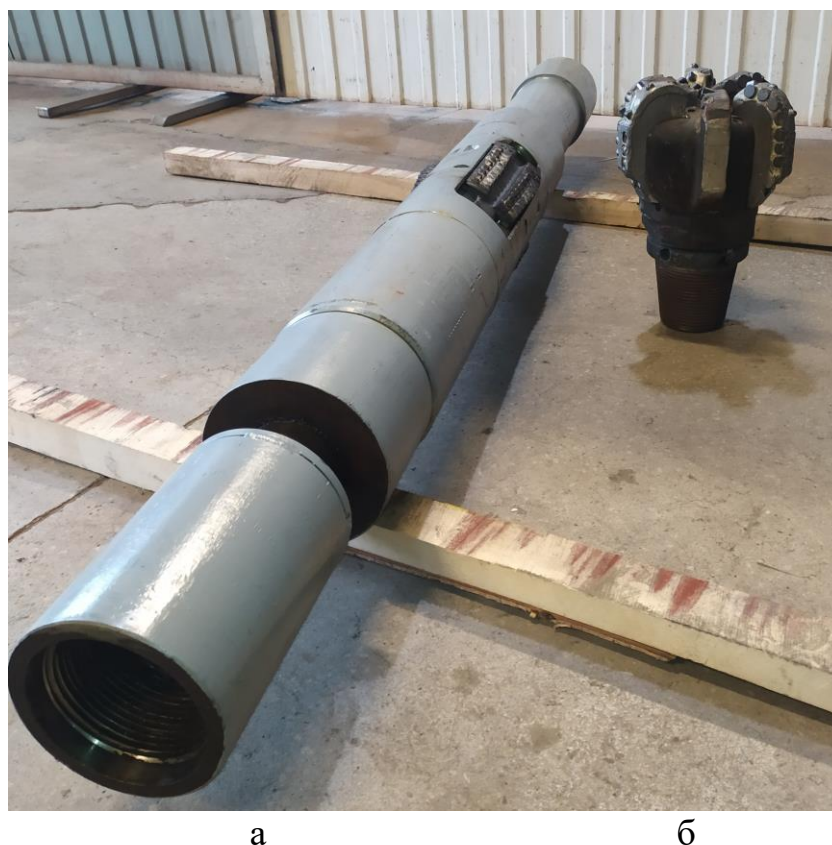
Рисунок 9 – Раздвижной расширитель РРМ 216/240 (а) и долото-расширитель ДР-216/242 (б)
