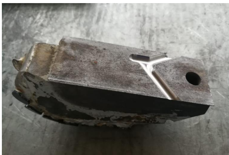
Рисунок 12 – Пазы для вымывания шлама на плашках долота-расширителя
