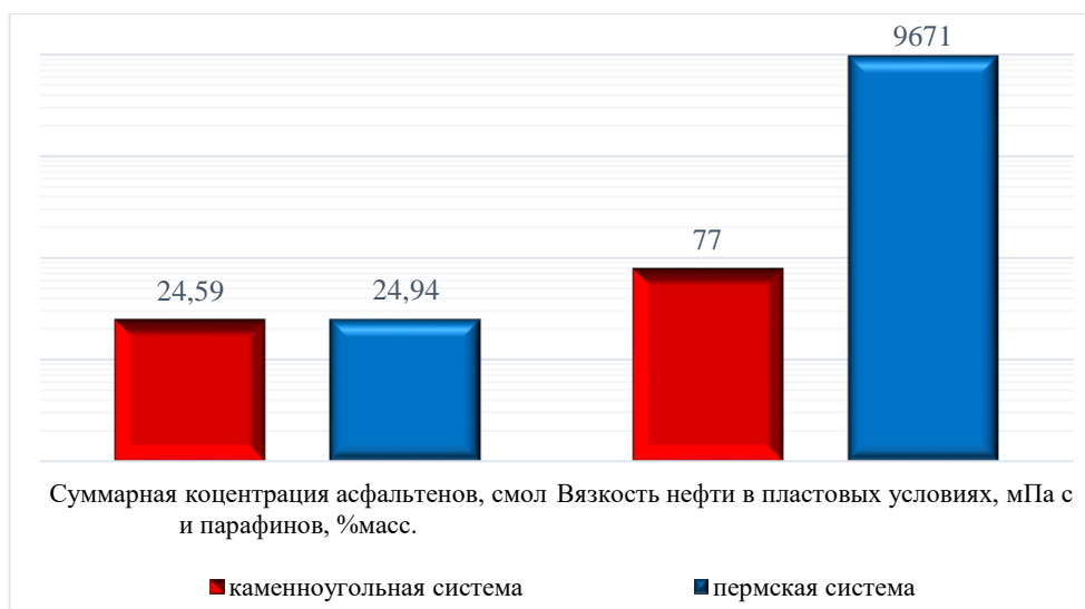
Рисунок 36 – Сравнительный анализ средних значений вязкости и суммарной концентрации асфальтенов, смол и парафинов в нефти пермской и каменноугольной систем
