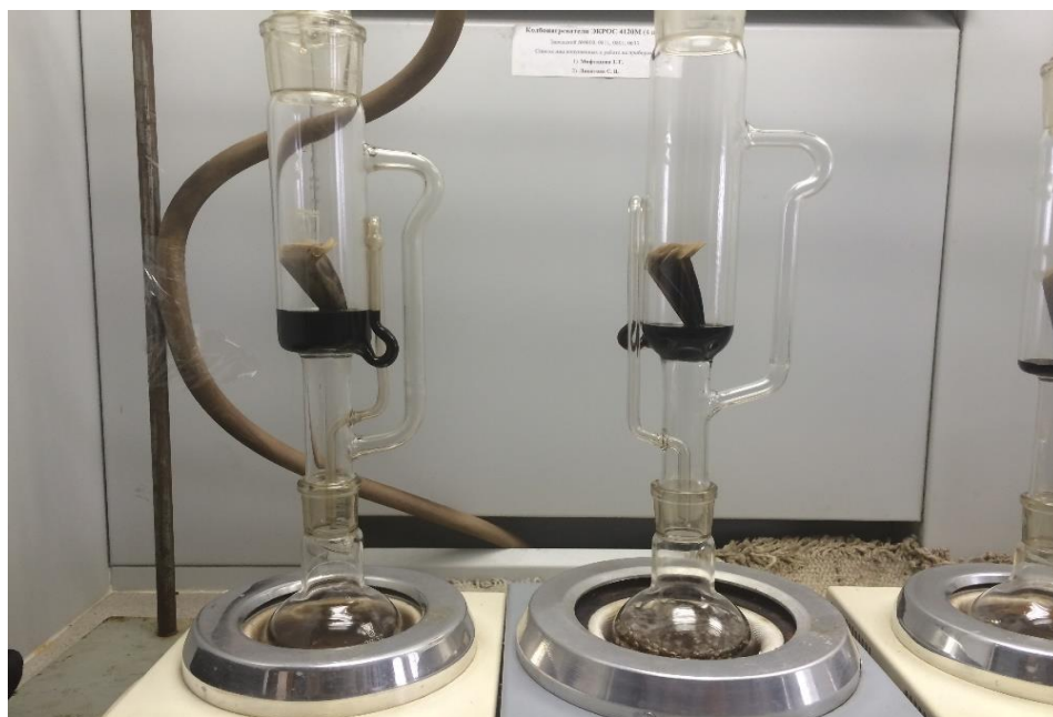
Рисунок 39 – Экстракция асфальтенов в аппаратах Сокслета
