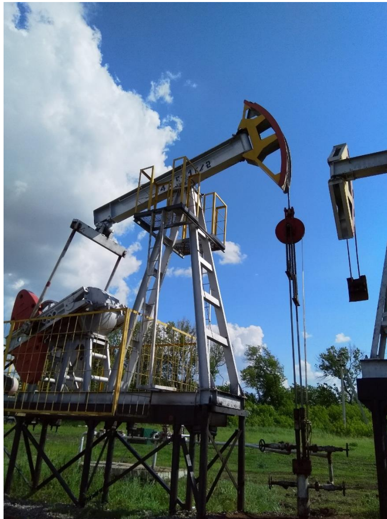
Рисунок 3.3 – Наземное оборудование разработанной установки на скважине № 4551г НГДУ «Бавлынефть»
