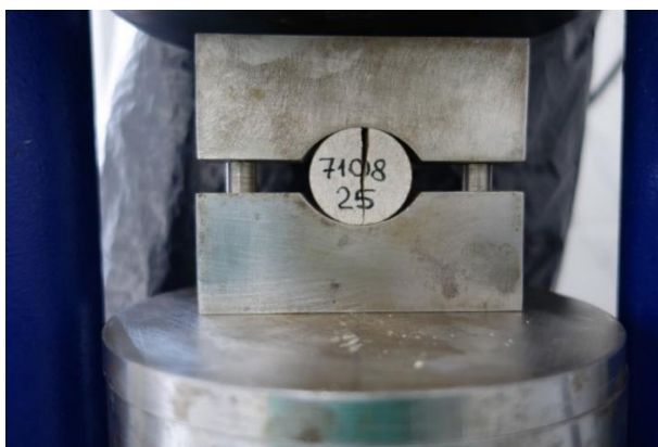
Рисунок 3.6 – Пример разрушения образцов керна при испытании (бразильский тест)
