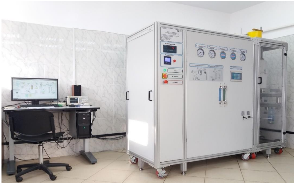
Рисунок 3.10 – Установка для исследования прочностных свойств керна «ПИК-УИДК/ПЛ»
