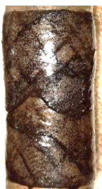
Рисунок 4.17 – Пример образца из керна с образованием зон уплотнения после проведения испытаний на всестороннее сжатие
