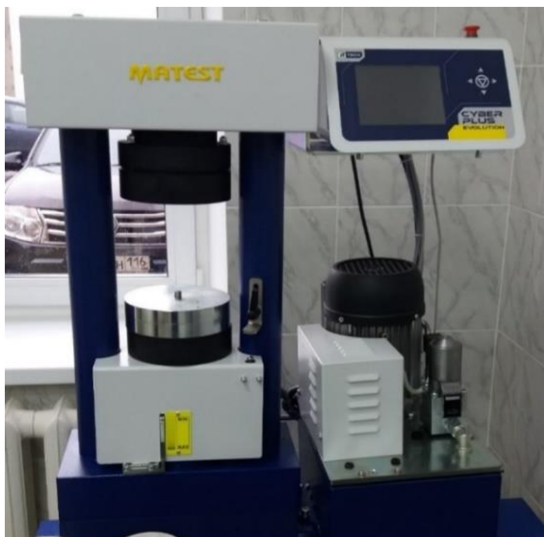
Рисунок 3.7 – Автоматический двухдиапазонный пресс на сжатие/изгиб MATEST E161-01N
