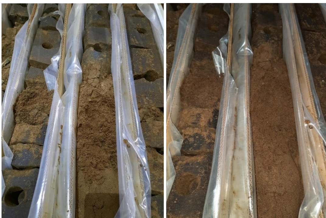
Рисунок 4.12– Примеры интервалов керна продуктивной части с полной потерей механической прочности
