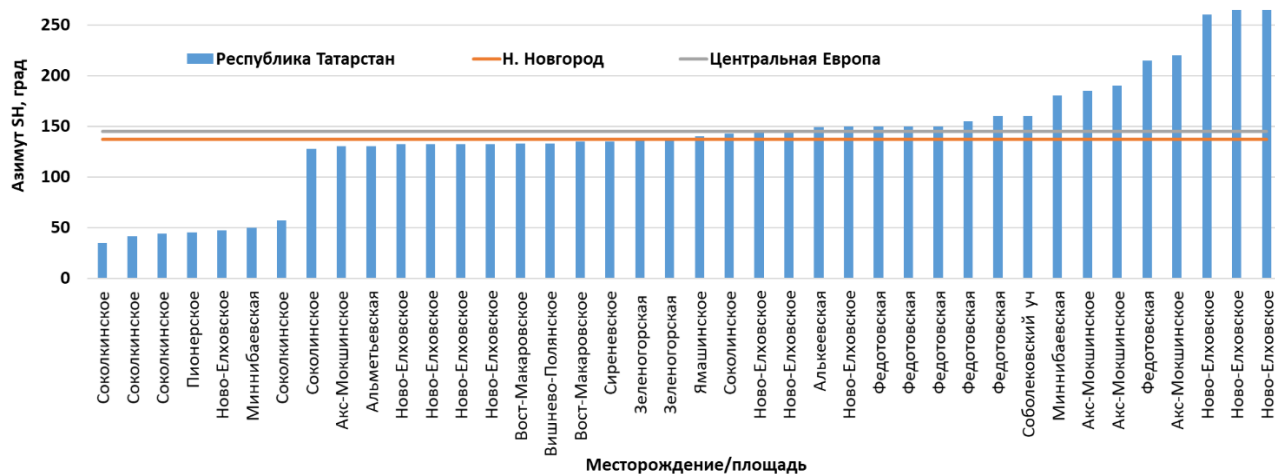
Рисунок 2.28 – Азимуты максимального горизонтального напряжения по месторождениям Республики Татарстан
