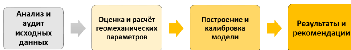
Рисунок 1.22 – Основные этапы 1D геомеханического моделирования
