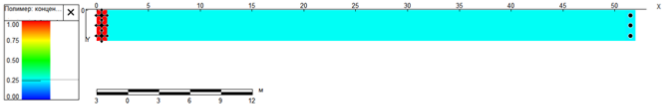
Рисунок 2.6.1 – Изменение нормализованной концентрации полимера в модели, состоящей из одной ячейки размером 50 м между скважинами.
