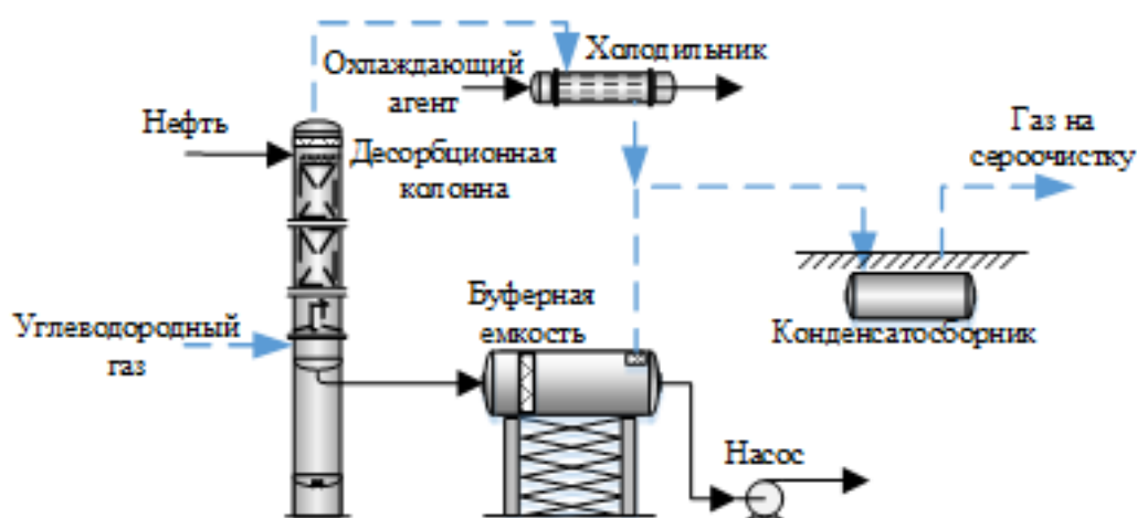
Рисунок 1.3.1 – Технологическая схема отдувки сероводорода из нефти в десорбционной колонне
