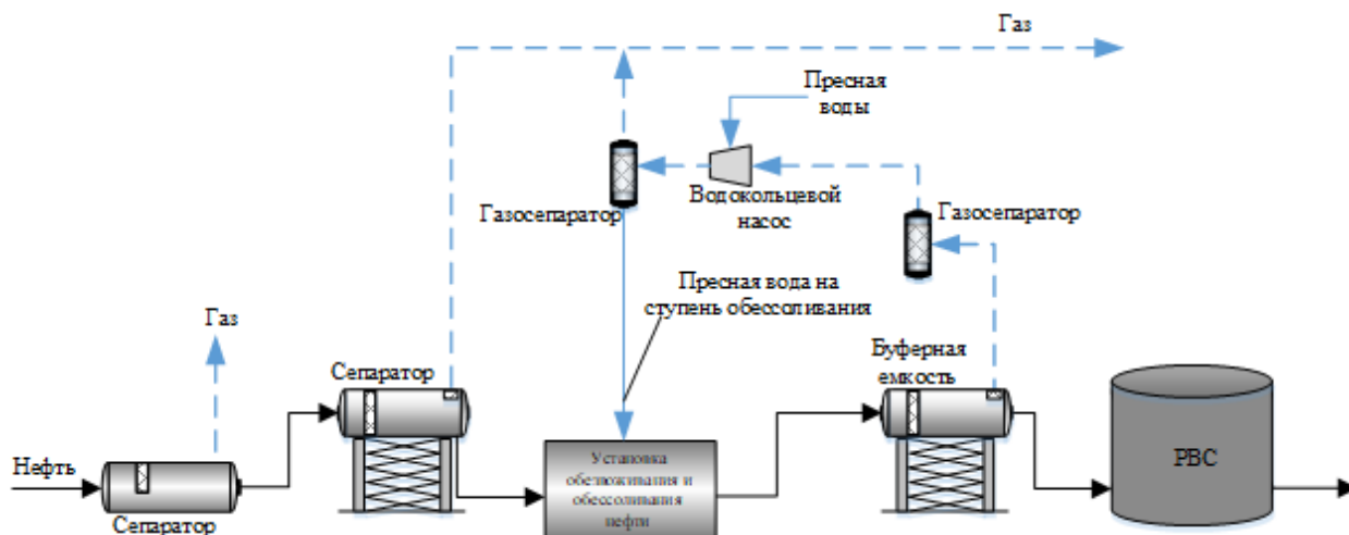
Рисунок – 1.1.2 – Принципиальная схема удаления сероводорода из нефти с использованием водокольцевого насоса
