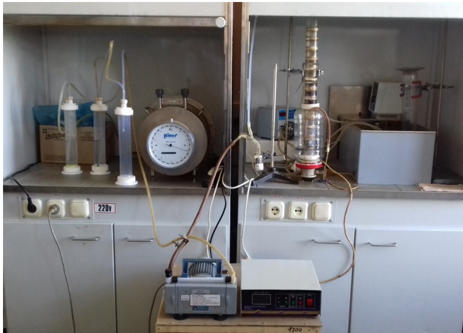
Рисунок 3.1.1 - Лабораторная установка для изучения влияния вакуума и совместного воздействия вакуума и ультразвука на нефть для удаления растворенных газов с помощью комплекса ЛУК 0,125/50- О
