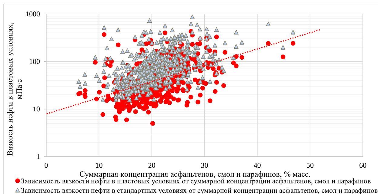
Рисунок 4 - Зависимость вязкости нефти в пластовых и стандартных условиях от суммарной концентрации асфальтенов, смол и парафинов для залежей каменноугольной системы
