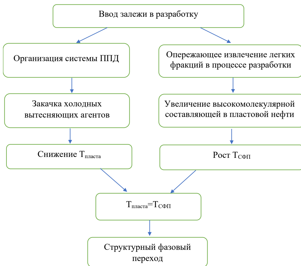
Рисунок 7 – Принципиальная схема возникновения структурного фазового перехода в нефти в процессе разработки
