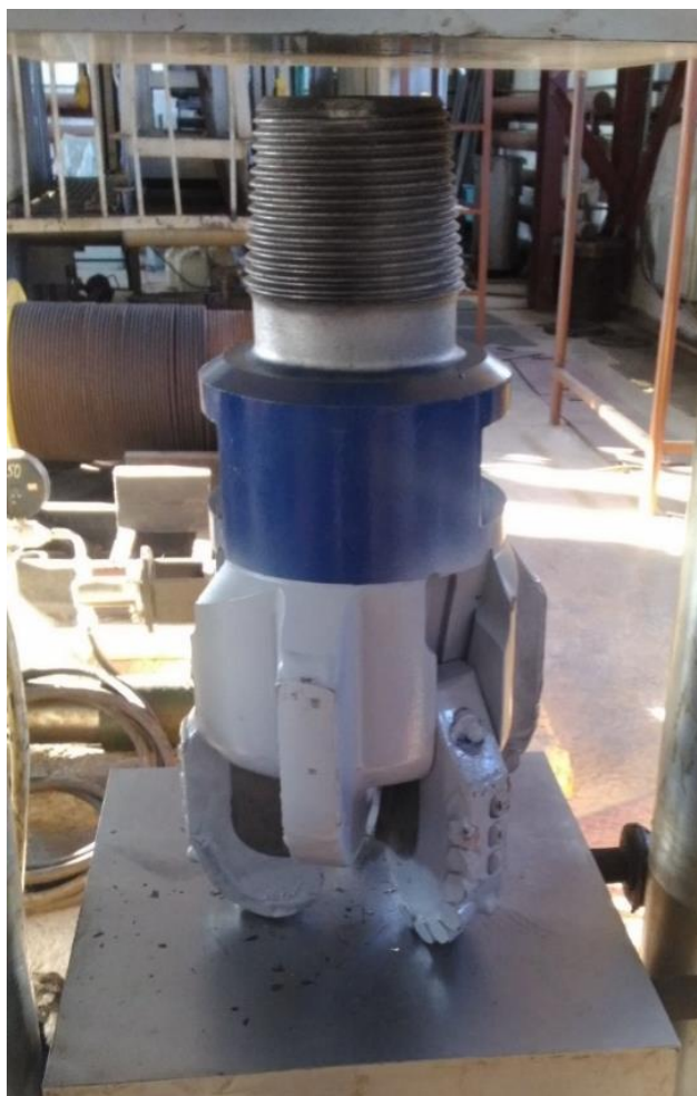
Рисунок 4.2 – Испытание долота-расширителя ДР-216/242 на вертикальном гидравлическом прессе МИРИ- 500/1000К
