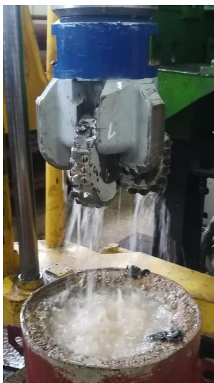
Рисунок 4.16 – Долото-расширитель ДР-216/242 после бурения с одновременным расширением
