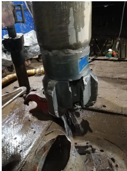
Рисунок 4.17 – Выпадение плашек на ДР-216/242
