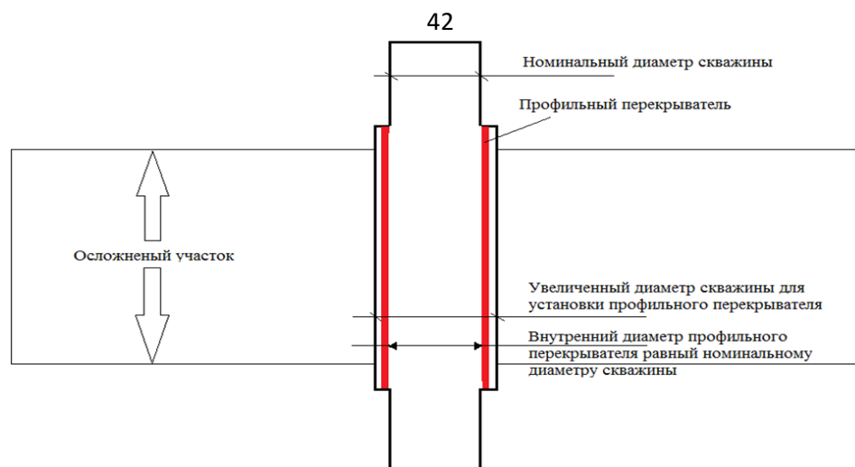
Рисунок 2.1 – Установленный ПП с сохранением номинального диаметра скважины
