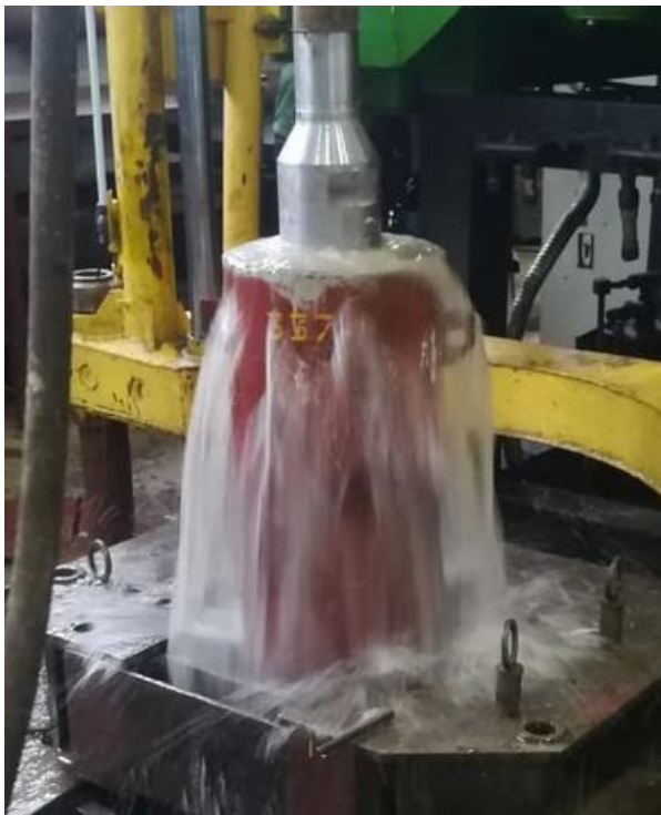
Рисунок 4.8 – Процесс вывода плашек долота-расширителя из транспортного в рабочее положение и забуривание расширенного ствола
