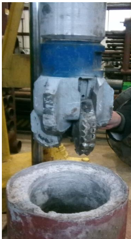
Рисунок 4.9 – Проверка хода плашек после среза штифтов и зарезки в стенки скважины
