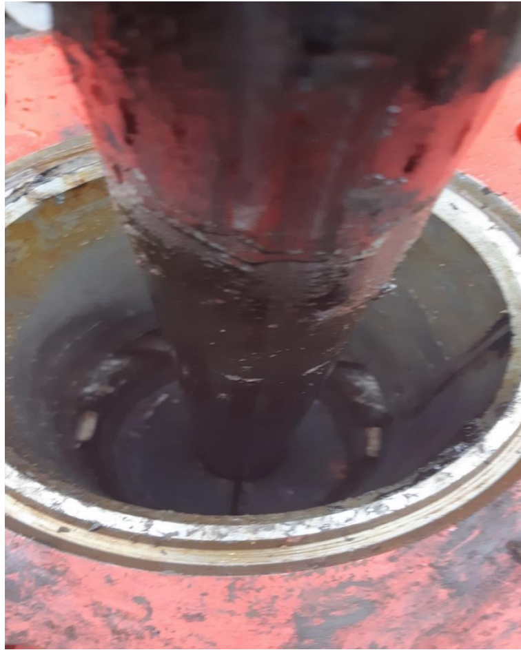
Рисунок 3.10 – Герметизация ДК труб симметричными плашками превентора ППС-2Ф-180×21-2К
