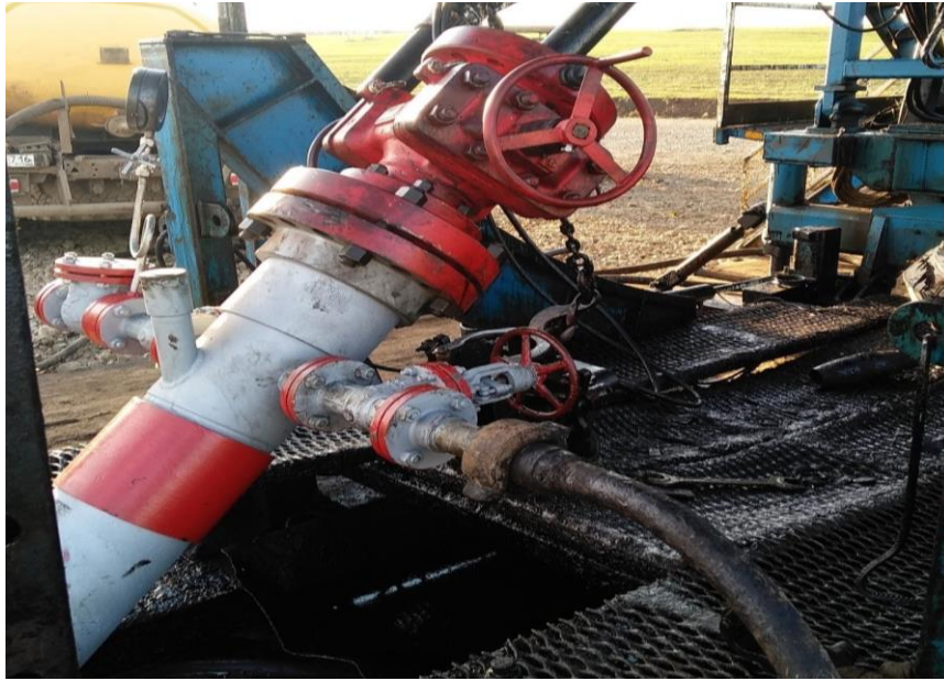
Рисунок 3.2 – Превентор, соединённый с устьевой арматурой сменным переходным кольцом диаметром 445 мм
