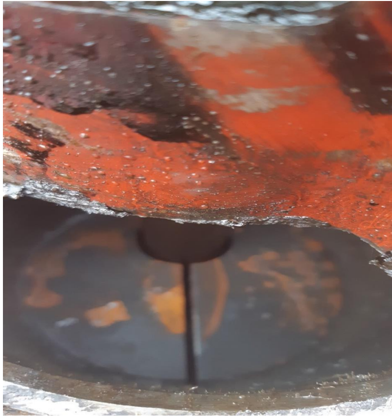
Рисунок 3.8 – Герметизация КК труб ассиметричными плашками превентора ППС-2Ф-180×21-2К
