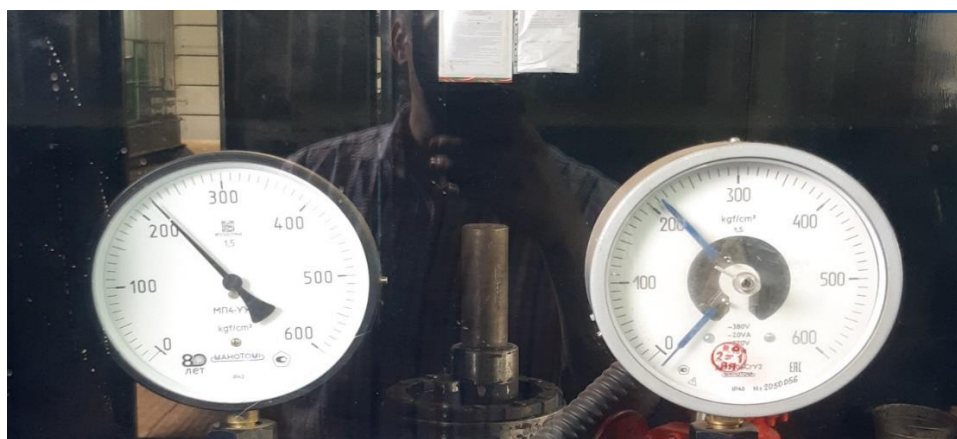
Рисунок 3.21 – Опрессовка крепления КФ-12 на максимально допустимое гидравлическое давление 21,0 МПа
