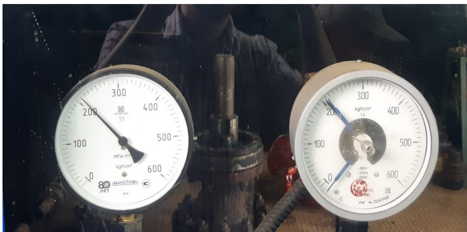
Рисунок 3.20 – Опрессовка крепления КФ-6 на максимально допустимое гидравлическое давление 21,0 МПа
