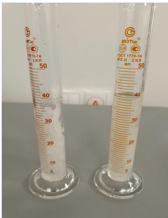
Рисунок 5.1 – Тампонажная масса, полученная после смешения в цилиндрах низко модульного жидкого стекла и раствора хлористого кальция (слева – после слива прореагировавшей жидкости из цилиндра, справа – до слива жидкости)
