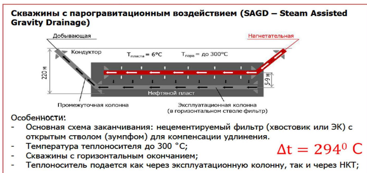
Рисунок 1 – Схема конструкции ПГД скважин на Лыаельской площади Ярегского месторождения
