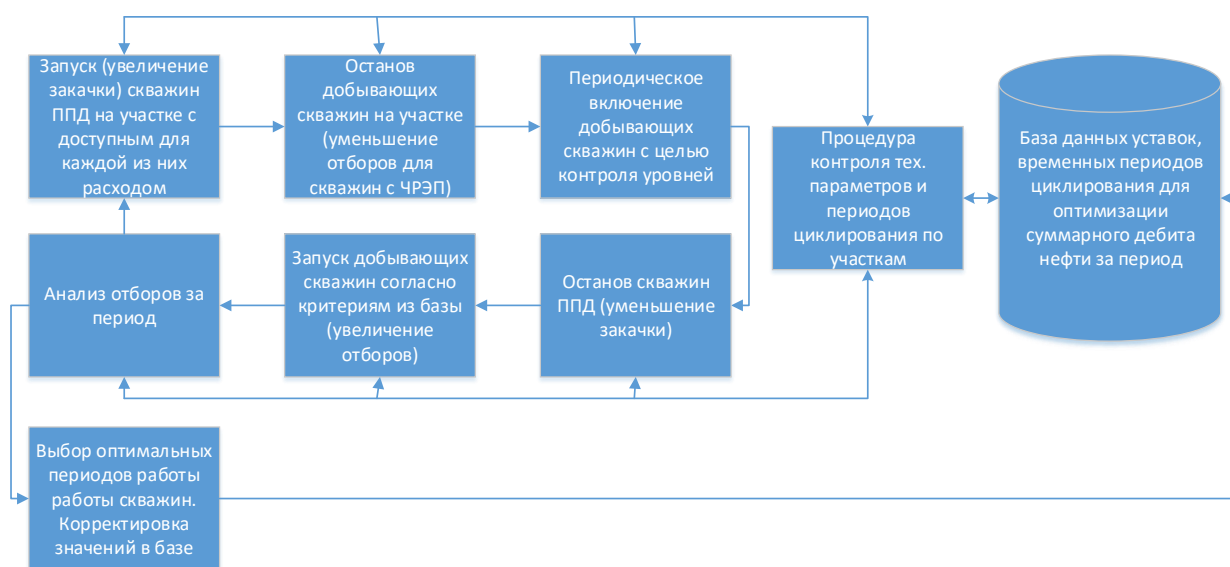
Рисунок 12 – Блок-схема процесса организации нестационарного заводнения с непрерывным наблюдением и обратной связью
