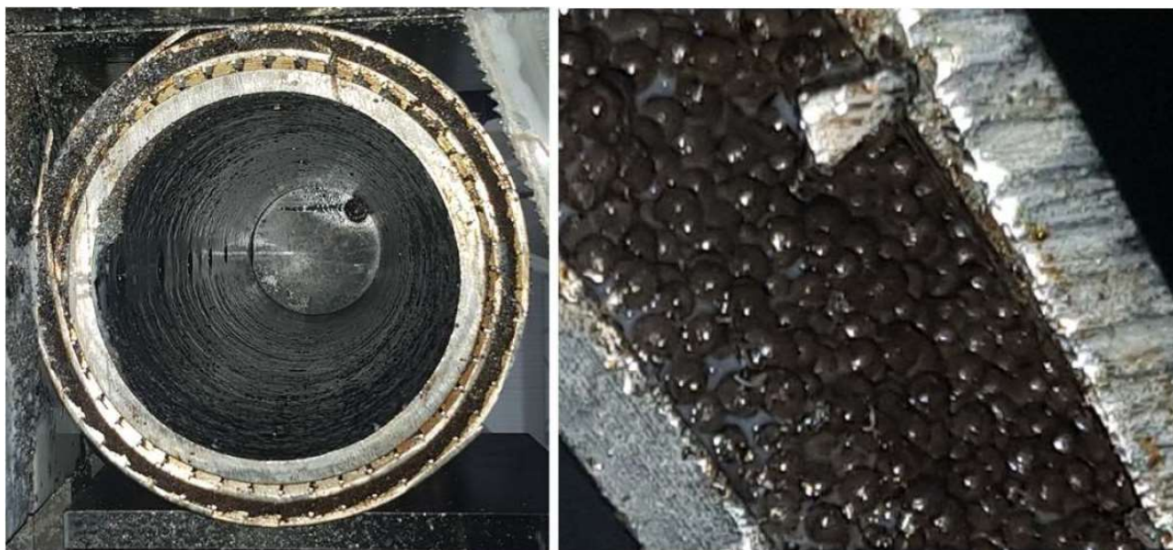
Рисунок 4.9 – Поперечный срез фильтра № I, имеющего гравийную набивку (пропант). Справа фотография с 25-ти кратным увеличением
