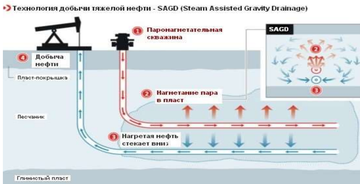
Рисунок 1.1 – Схема принципа эксплуатации месторождения высоковязкой нефти посредством парогравитационного дренирования
