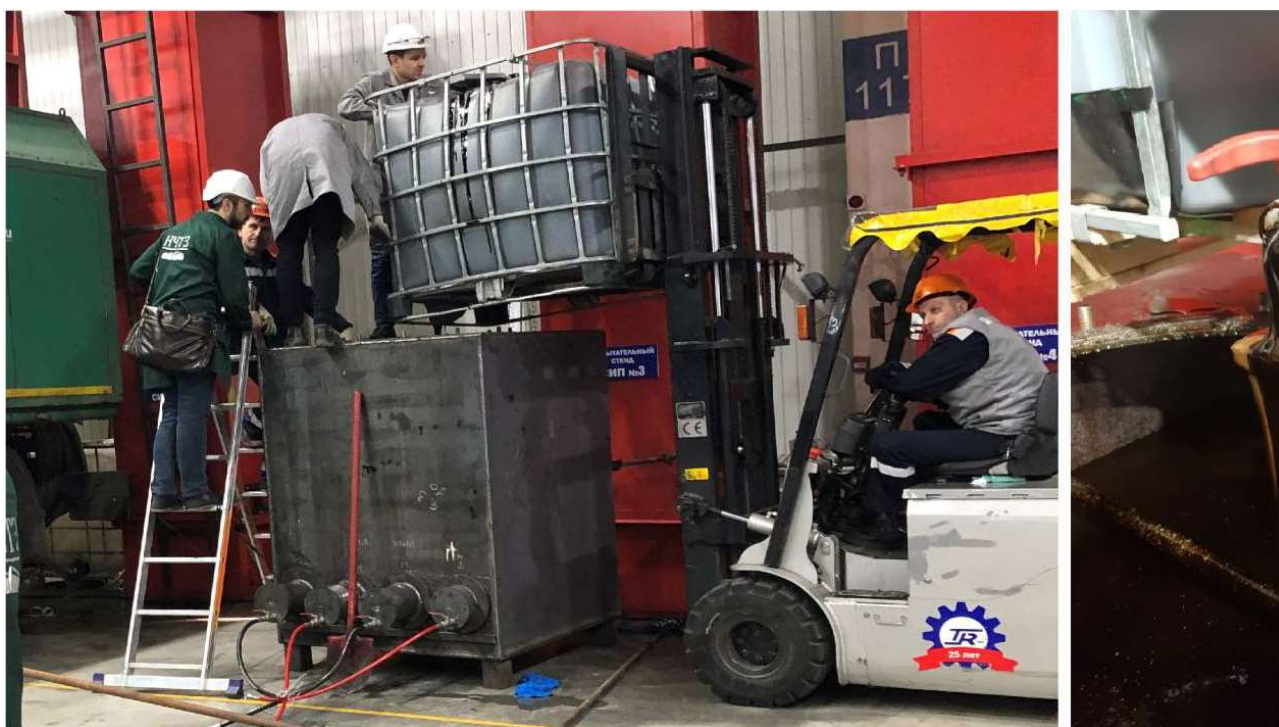
Рисунок 4.4 – Заливка в испытательный стенд пластового флюида с Ярегского месторождения
