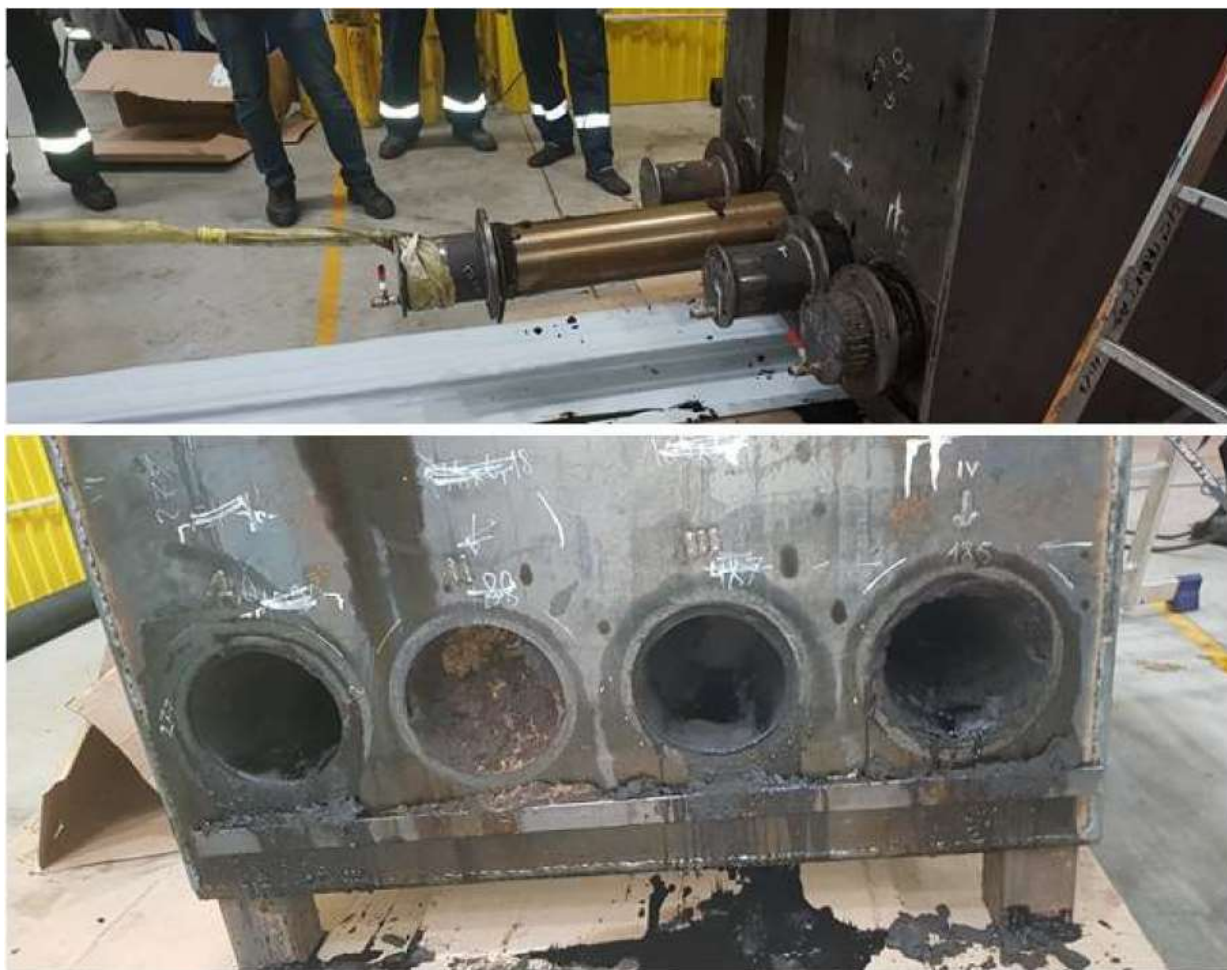
Рисунок 4.7 – Извлечение образцов фильтров для контрольных замеров и распиловки
