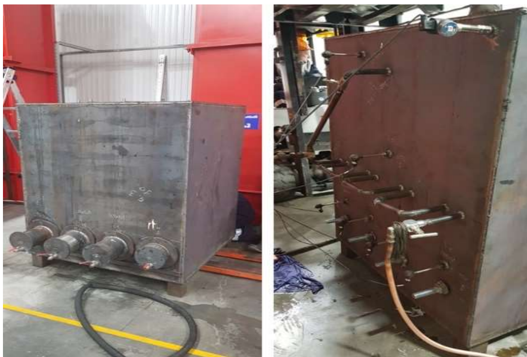
Рисунок 4.2 – Стенд для оценки эффективности скважинных фильтров (вид спереди и сзади)
