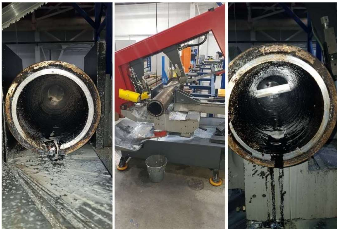
Рисунок 4.8 – Распиливание образца № I по заглушке и по фильтр-элементу
