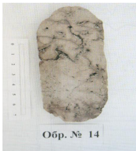
Рисунок 2 – Известняки трещиноватые и стилолитизированные, неравномерно нефтенасыщенные по порам, трещинам, кавернам выщелачивания и напластованию из скважин соответственно №№ 8576, 8555 и 8551 залежи 655 Зеленогорской площади
