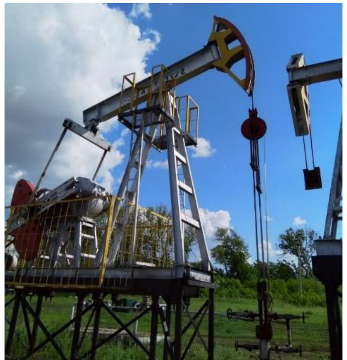
Рис. 5 – Двухлифтовая УСШН с одним приводом на скважине
