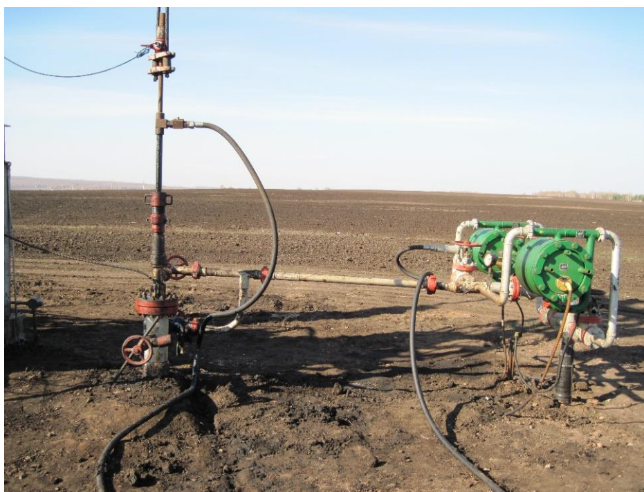
Рисунок 5.4 – Устье скважины, оборудованной установкой для ОРЭ с разделительным поршнем и полыми штангами
