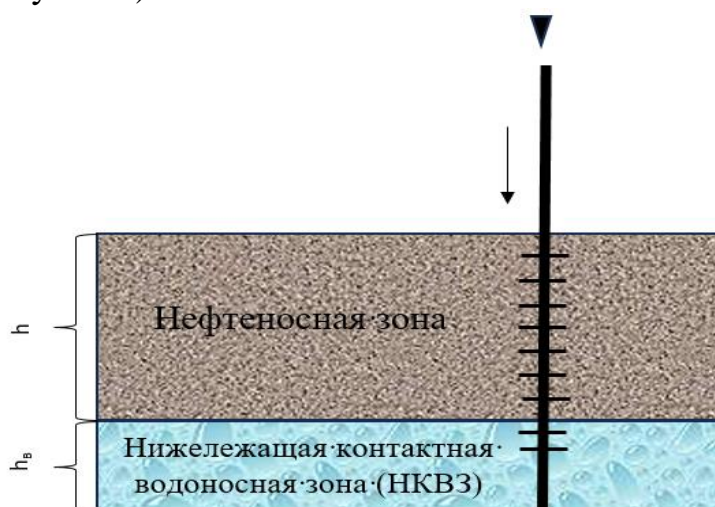
Рисунок 5 - Схема нефтеносной залежи, состоящей из нефтеносной зоны и нижележащей контактной водоносной зоны (НКВЗ)
