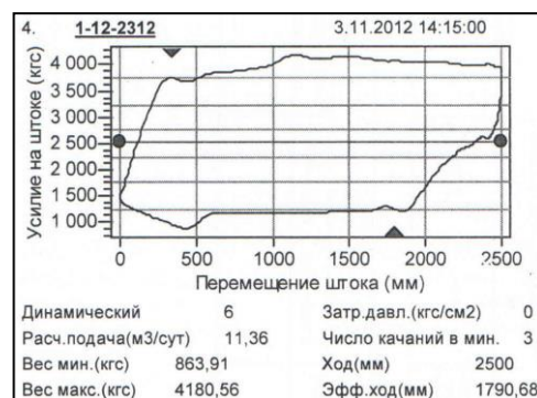
Рисунок 19 – Динамограмма работы установки с разделительным поршнем и подъёмом продукции по ЭК
