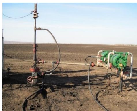
Рисунок 14 – Устье скважины, оборудованной установкой для ОРЭ с разделительным поршнем и полыми штангами
